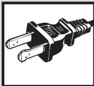
**CET APPAREIL EST DOTÉ D'UN CORDON À FICHE POLARISÉE (une lame est plus large que l'autre). Afin de réduire les risques d'électrocution, cette fiche n'enfonce que dans un sens dans la prise électrique. Si la fiche ne s'insère pas dans la prise, retournez la fiche. Si elle ne s'adapte toujours pas, contactez un électricien qualifié afin d'installer la prise appropriée.**
