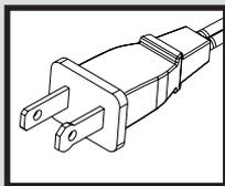
**CET APPAREIL EST ÉQUIPÉ D'UNE FICHE POLARISÉE (une branche est plus large que l'autre). Pour réduire les risques de choc électrique, la fiche n'enfonce dans les prises polarisées que dans un sens. Si la fiche ne rentre pas bien dans la prise, inversez-la. Si elle ne pénètre toujours pas parfaitement, faites changer la prise par un électricien qualifié.**
