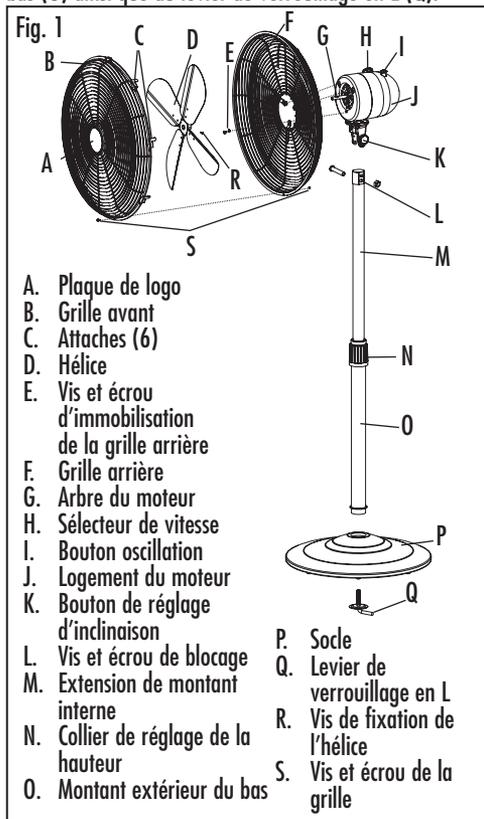
1. Introduisez l'extrémité filetée du levier de verrouillage en L dans le trou du capot du soacle.
